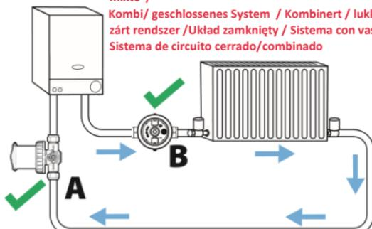
**Notă** – În ambele diagrame, poziția A reprezintă modalitatea recomandată, iar B alternativă de instalare.
